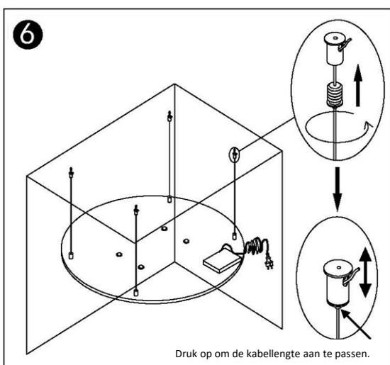
Rijg de ophangdraad door het gat in de plafondbevestigingsstukken. Schroef de vergrendelingsstukken met schroefdraad er vingervast in. Niet volledig aandraaien. Herhaal dit voor alle 4 de onderdelen. Trek voorzichtig aan de ophangdraad zodat het verwarmingselement waterpas hangt. Draai vervolgens de vergrendelingsstukken vast om de draad op zijn plaats te vergrendelen.
