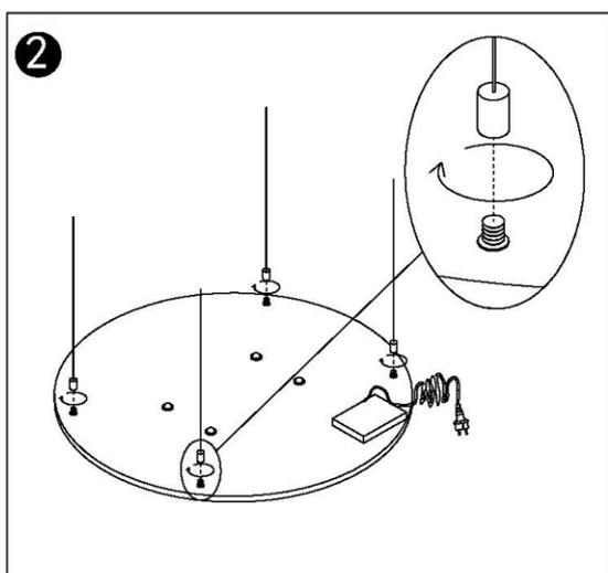
Schroef de schroefdraadkragen op de schroefdraadbouten aan de achterkant van het verwarmingselement.
