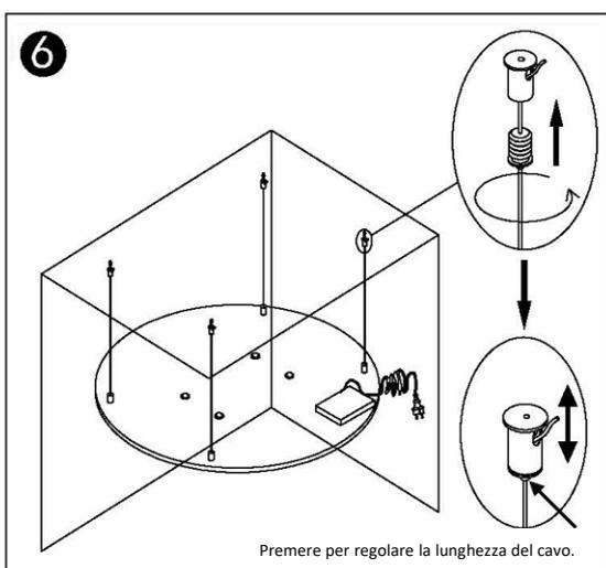
Infilare il filo di sospensione attraverso il foro dei pezzi di montaggio a soffitto. Avvitare i pezzi di bloccaggio filettati a tenuta di dita. Non serrare completamente. Ripetere l'operazione per tutti e 4 i pezzi. Tirare delicatamente il filo di sospensione in modo che il riscaldatore sia sospeso in piano. Infine, stringere i pezzi di bloccaggio per bloccare il filo in posizione.
