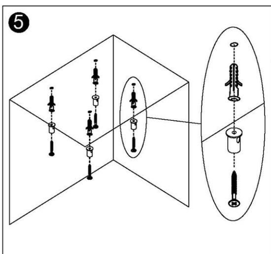
Stecken Sie die Dübel in die gebohrten Löcher, schrauben Sie je eine Schraube in die 4 Deckenhalterungen und befestigen Sie sie an der Deckenfläche.
