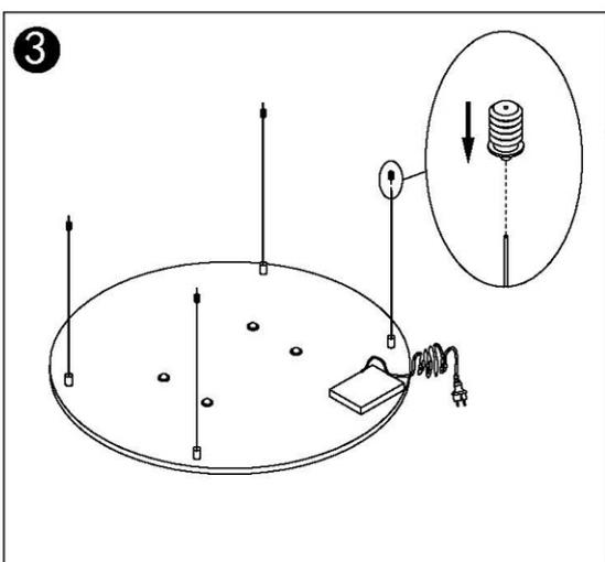
Fädeln Sie den Aufhängungsdraht durch das breitere Ende der Gewindegewandstücke.
