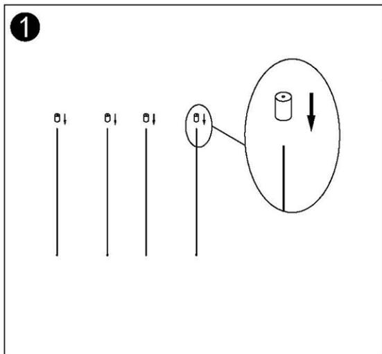
Pase el cable de suspensión por el extremo más ancho de los collares roscados y tire del cable hasta el final del pequeño orificio hasta llegar al "tope" en el extremo de cada cable.
