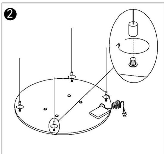
Atornille los collares roscados en los pernos roscados de la parte posterior del calentador.
