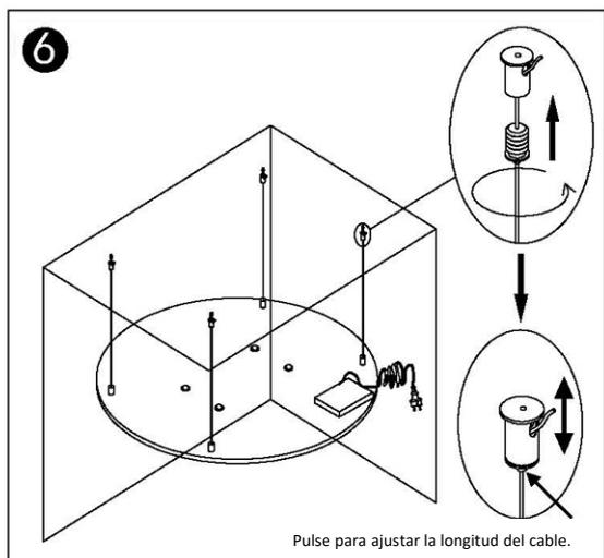
Pase el cable de suspensión por el orificio de las piezas de montaje en el techo. Atornille las piezas roscadas de bloqueo con los dedos. No apriete del todo. Repita la operación con las 4 piezas. Tire suavemente del cable de suspensión para que el calefactor quede suspendido a nivel. A continuación, apriete finalmente las piezas de bloqueo para fijar el cable en su sitio.
