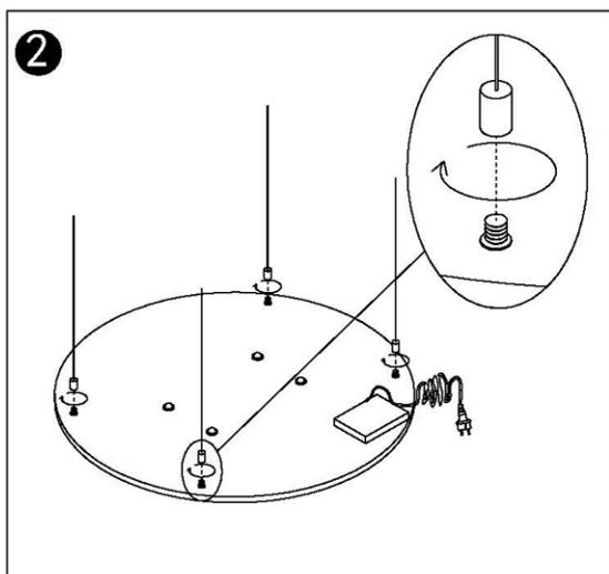
Schrauben Sie die Gewindehülsen auf die Gewindebolzen auf der Rückseite des Heizgeräts.
