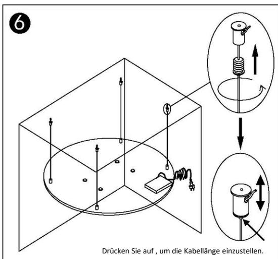
Fädeln Sie den Aufhängungsdraht durch das Loch in den Deckenbefestigungsstücken. Schrauben Sie die Gewindegewindestücke handfest ein. Ziehen Sie sie nicht ganz fest. Wiederholen Sie diesen Vorgang für alle 4 Teile. Ziehen Sie vorsichtig am Aufhängungsdraht, damit das Heizgerät waagrecht aufgehängt ist. Ziehen Sie dann die Verriegelungsstücke fest, um den Draht zu fixieren.
