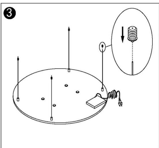
Enfilez le fil de suspension à travers l'extrémité la plus large des pièces de blocage filetées.
