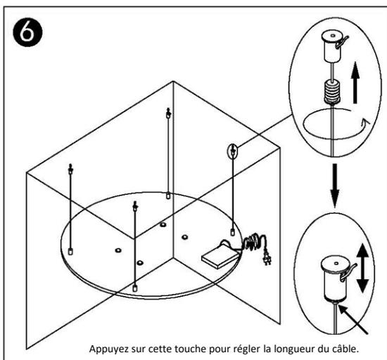
Enfilez le fil de suspension dans le trou des pièces de fixation au plafond. Vissez les pièces de verrouillage fileté en les serrant à la main. Ne serrez pas complètement. Répétez l'opération pour les 4 pièces. Tirez doucement sur le fil de suspension pour que l'appareil soit suspendu à niveau. Puis serrez finalement les pièces de blocage pour verrouiller le fil en place.
