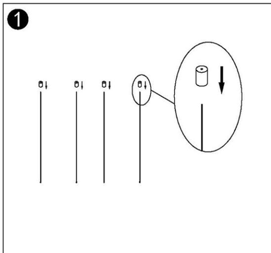
Fädeln Sie den Aufhängungsdraht durch das breitere Ende der Gewindehülsen und ziehen Sie den Draht ganz durch das kleine Loch, bis der "Anschlag" am anderen Ende des Drahtes erreicht ist.
