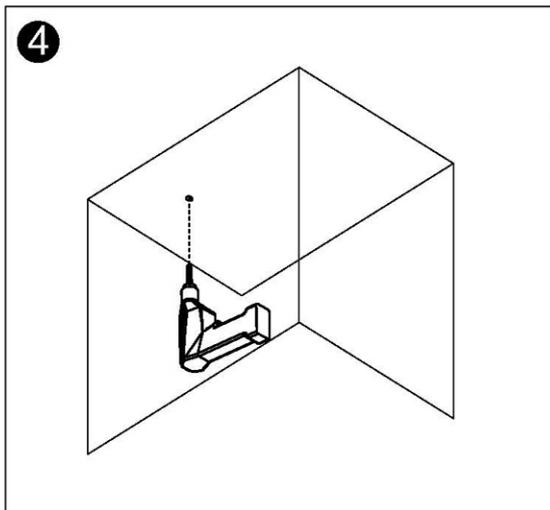
Bohren Sie die 4 Löcher zur Aufnahme der 4 Dübel für die Deckenbefestigungsteile. Die Löcher sollten 46 cm voneinander entfernt sein und eine Diagonale von 65 cm haben.
