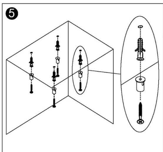
Inserte los tapones en los agujeros taladrados, introduzca un tornillo en cada una de las 4 piezas de montaje en el techo y fije cada una en la superficie del techo.
